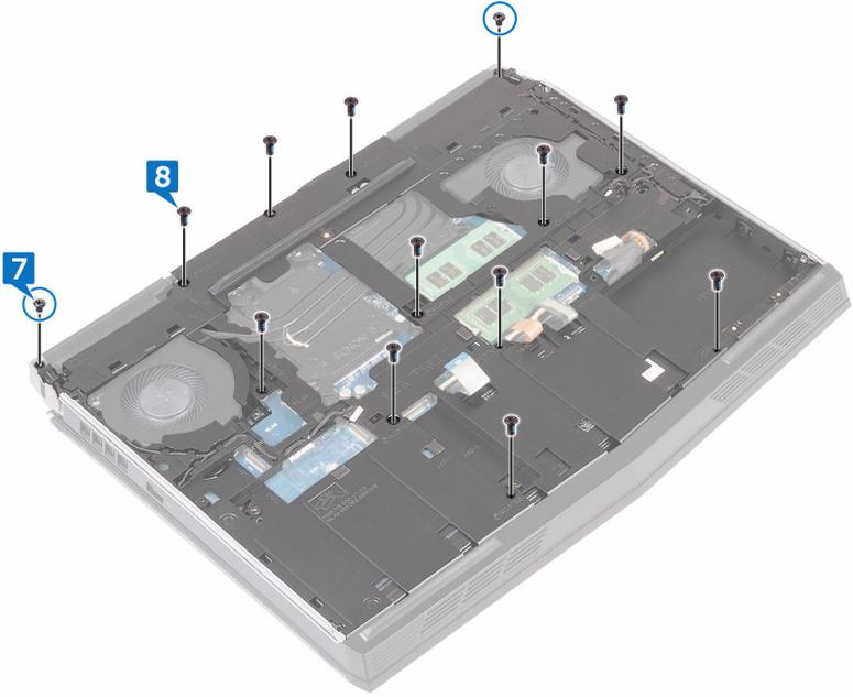
9 Levante la base del equipo para extraerla del ensamblaje del reposamanos.
