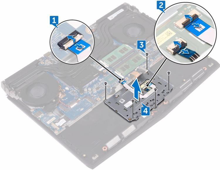
5 Levante la superficie táctil para extraerla del ensamblaje del reposamanos.
